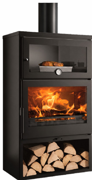
ESTUFA LEÑA ZAMORA ECODESIGN 621540036 7,1 kW. Alto rendimiento para menor consumo. Con horno. Calienta espacios de hasta 220 m³. Compatible con troncos de hasta 50 cm. Salida humo horizontal 150-153 mm. 100 x 56,2 x 48,1 cm. 1249,00€
